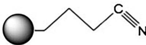
Slika 5. Struktura površine cijanopropil silikagel stacionarne faze
