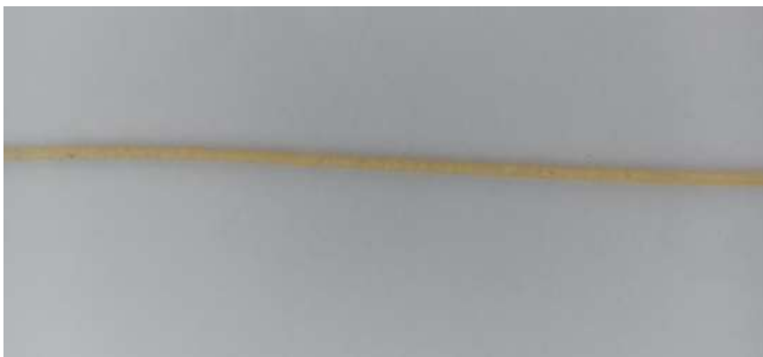
Slika 13. Ekstrudirani filament sa PEO kao osnovnim polimerom
