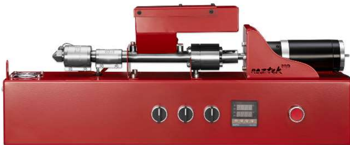
Slika 10. Ekstruder Noztek Pro (Noztek, Velika Britanija) za izradu filamenata metodom ekstruzije topljenjem (Noztek website, 2013).
