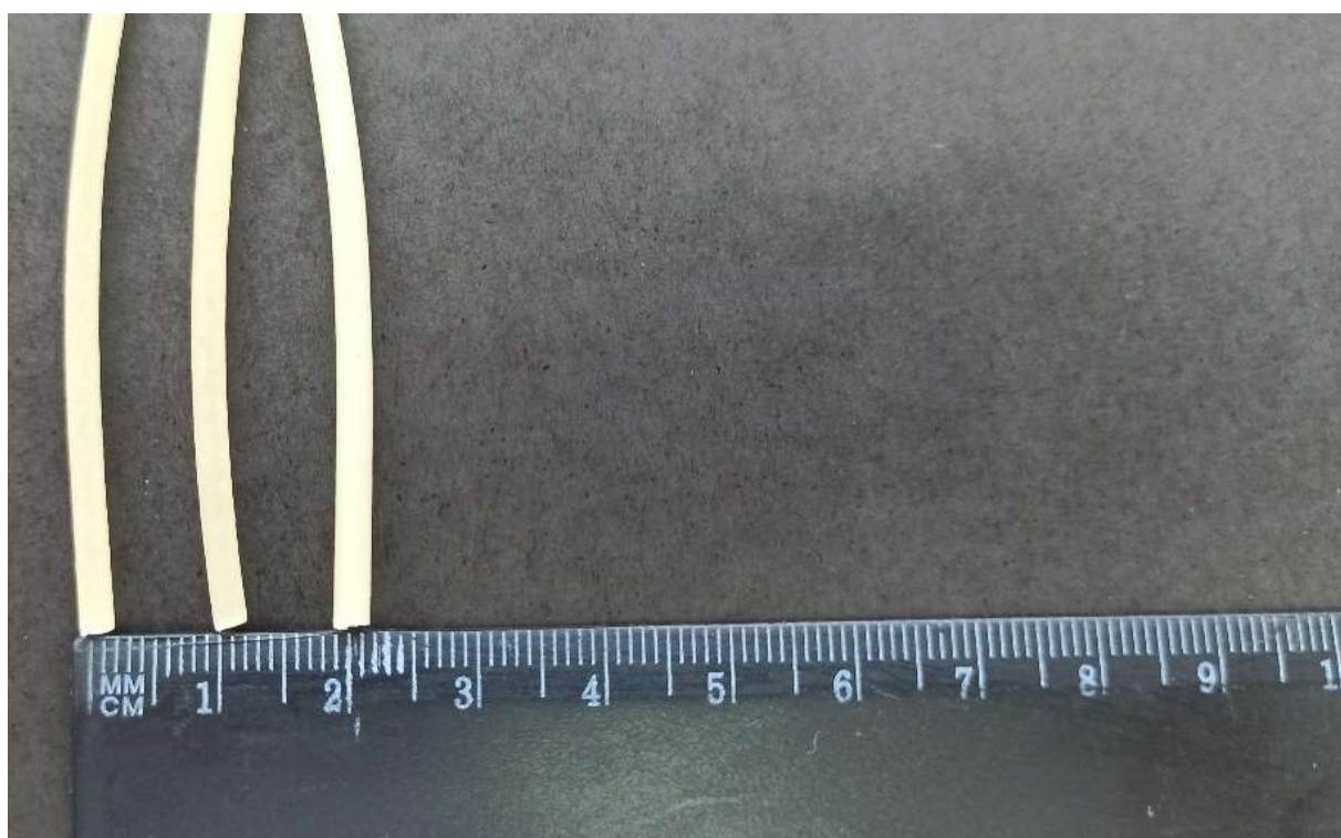
Slika 25. PVA ekstrudirani filamenti
