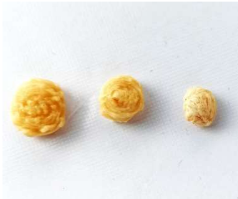
Slika 21. Neuspješno odštampane FDM 3D tablete od PEO-C3 filamena
