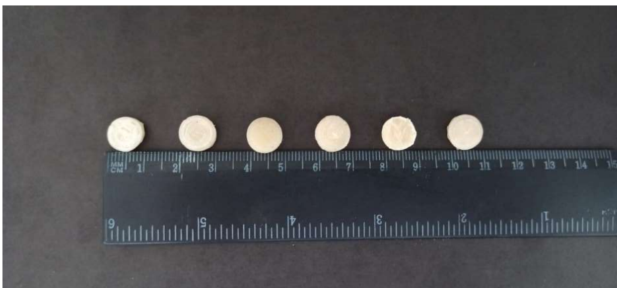
Slika 26. FDM 3D odštampane PVA tablete paracetamola
