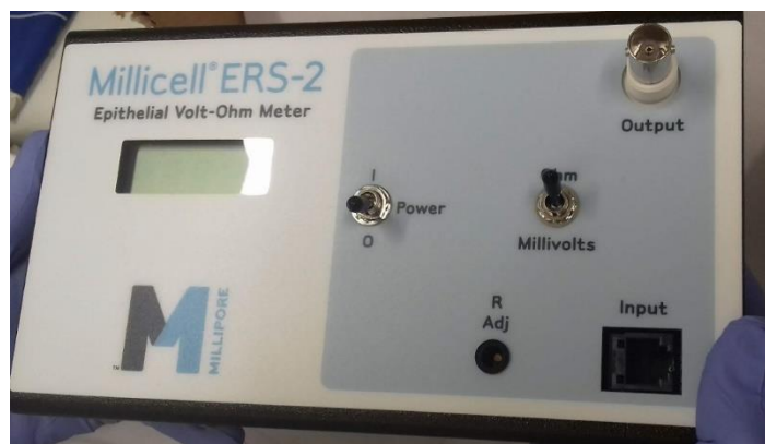
Slika 3.5. Voltmetar Millicell ERS-2 za merenje TEER
