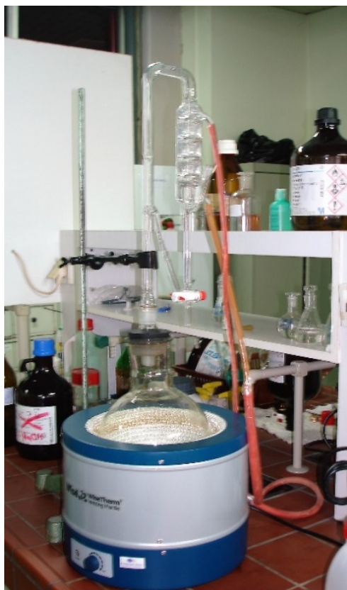
Слика 27. Апаратура за хидродестилацију по Clevenger-у.
