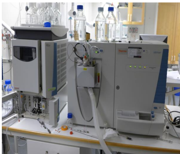
Slika 14. Aparatura za kvantifikaciju kortikosterona u plazmi eksperimentalnih životinja. (preuzeto sa: http://www.ultratrace.se/instrumentation/9-equipment/9-organic-lc-ms-2.html )
