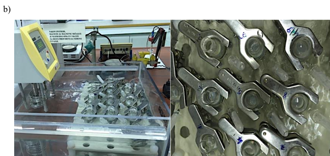
3.2.8. Ilustracija a) posebno pripremljenog, toplotom izolovanog epidermisa kože uha svinje; i b) postavke Franz -ovih difuzionih ćelija u vodenom kupatilu temperiranom na 32 °C.
