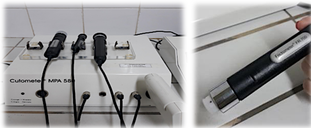
Slika 3.2.5. Uređaj Cutometer ® MPA 580 (levo) opremljen između ostalog i sondom Frictionmeter ® FR700 za različita tribološka ispitivanja (desno).
